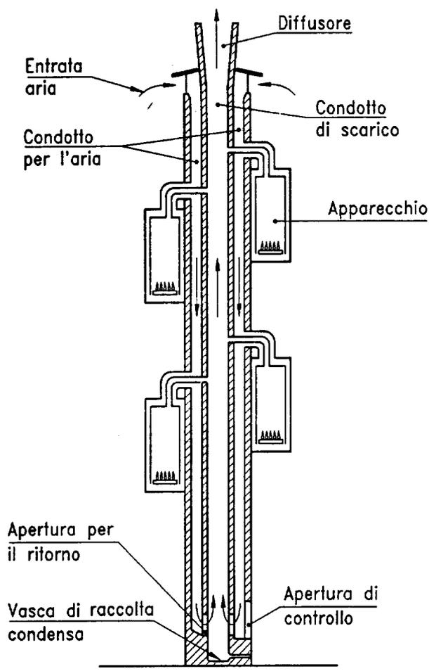
Fig. 21 — Apparati di tipo C<sub>22</sub> e C<sub>23</sub>
