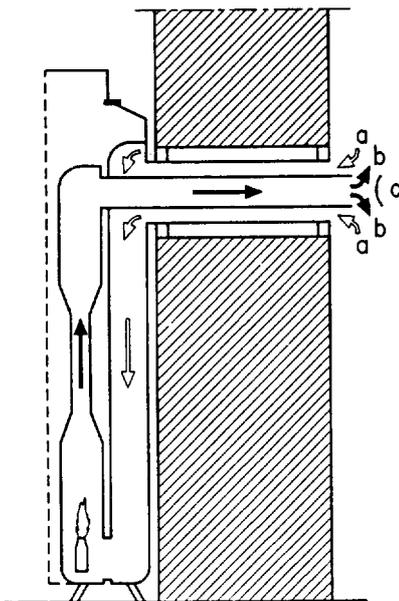
Fig. 19 — Schema di apparecchio di tipo C<sub>11</sub>
