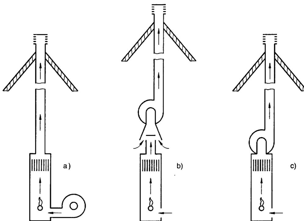
a) con ventilatore a monte - tipo B<sub>1 32</sub>
